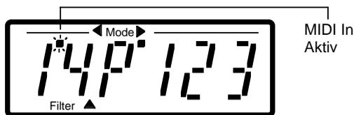
Der Punkt über den beiden Kanalziffern blinkt bei ankommenden MIDI Daten jeweils kurz auf. Dadurch sind Verkabelungsfehler schnell aufzuspüren.
